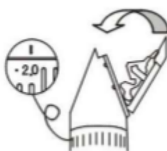
Montáž čepele pri nastavení dĺžky strihania 2 mm.
